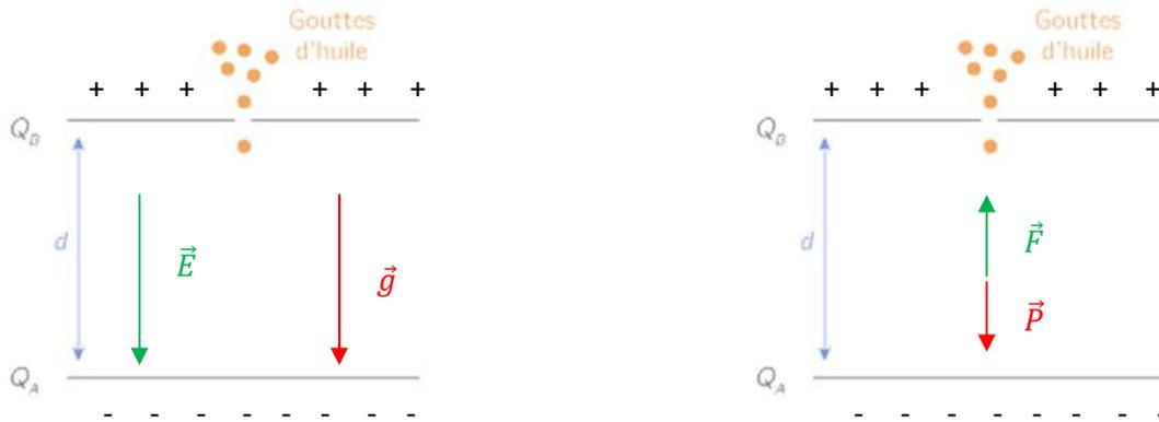
En modifiant la tension  $U$  entre les deux armatures de manière à ce que les gouttes aient un mouvement rectiligne et uniforme, il réussit à effectuer la première mesure historique de la charge élémentaire  $e$ .
