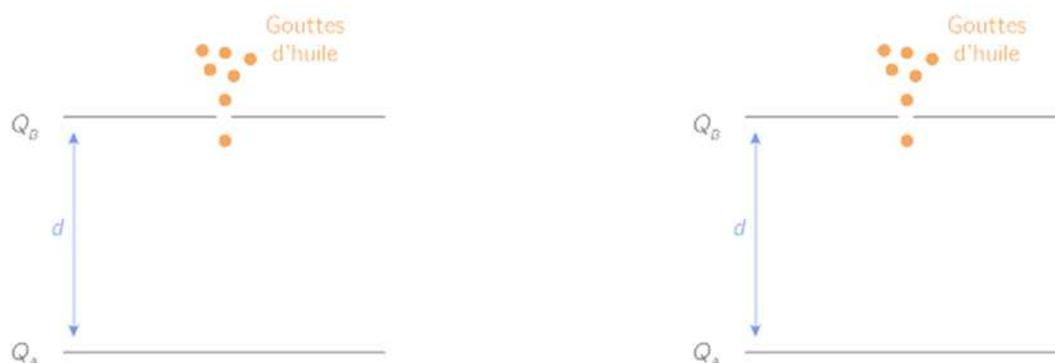
En modifiant la tension  $U$  entre les deux armatures de manière à ce que les gouttes aient un mouvement rectiligne et uniforme, il réussit à effectuer la première mesure historique de la charge élémentaire  $e$ .
