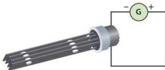
L'eau salée passe dans un appareil, appelé électrolyseur. Cet appareil est fait de plaques de titane polarisées dans lesquelles passe un courant électrique qui permet de transformer les ions chlorure en ions hypochlorite, du chlore naturel non stabilisé.
