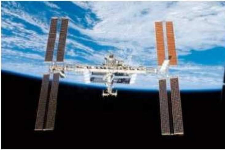
La station spatiale de masse  $m_{ISS} = 420 \text{ t}$  possède un mouvement quasi circulaire à  $h = 400 \text{ km}$  de la surface terrestre.
