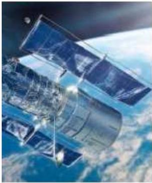
Le télescope spatial Hubble, a été lancé en 1990 dans le but de fournir des images de l'Univers dans le domaine du spectre ultraviolet, visible et proche infrarouge. Le télescope Hubble, de masse  $m = 11$  tonnes, est positionné sur une « orbite basse » à une altitude quasi constante  $h = 600$  km de la surface de la Terre.
